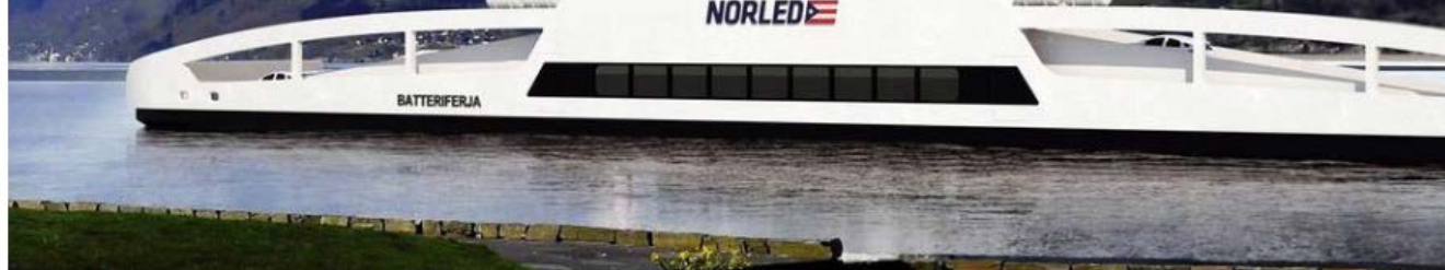
Først: Norleds ferje for 120 biler og 360 passasjerer blir verdens første og største 100 % batteridrevne ferje. Ill.: Fjellstrand Foto: Norled/Fjellstrand
